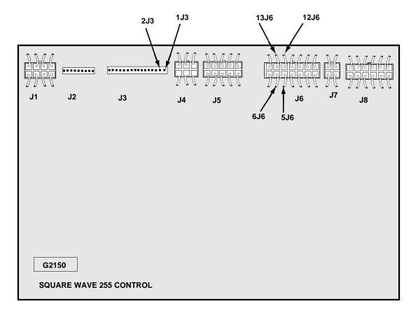
FIGURE F.1 - CONTROL BOARD CONNECTORS
